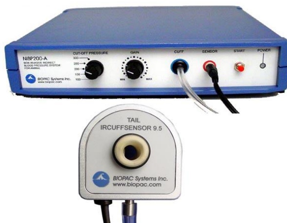
Рисунок 2.7 – Внешний вид системы NIBP200A («Biopac Systems, Inc.», США) для неинвазивной регистрации показателей артериального давления и частоты сердечных сокращений у мелких животных. Фото: И. Миронюк, 2025
