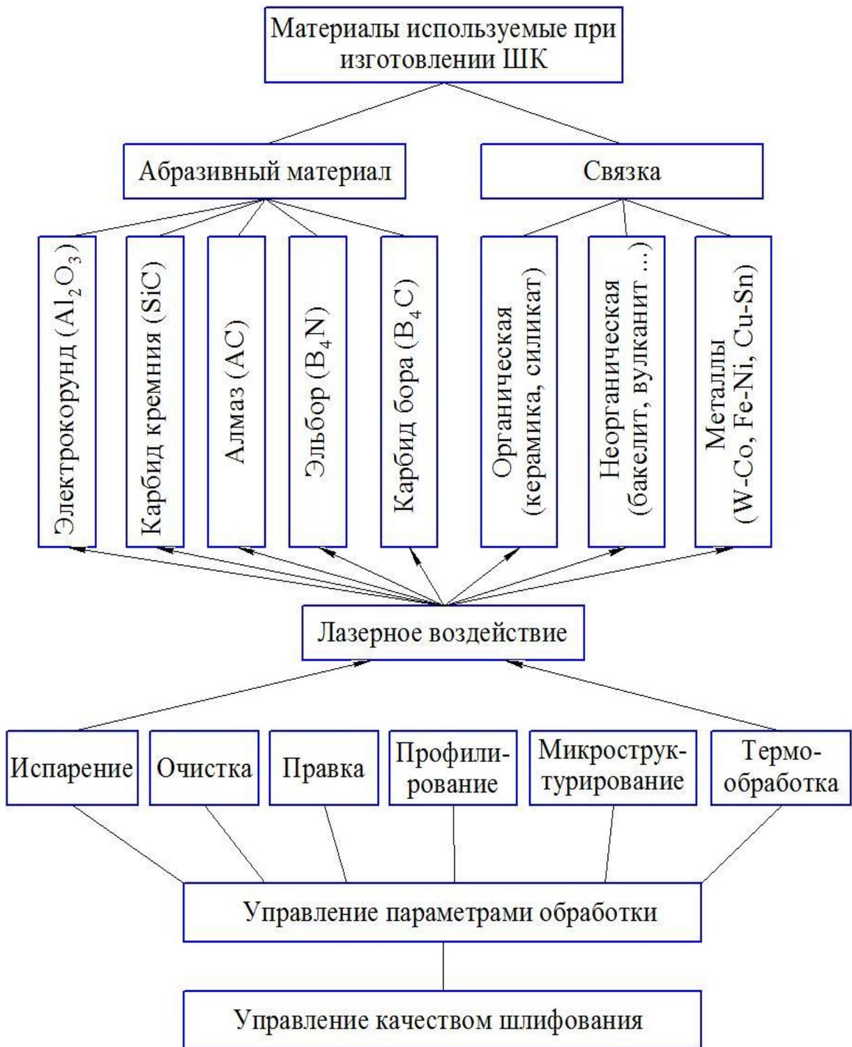
Рисунок 3. Применение лазерного излучения для формирования режущей поверхности ШК.
