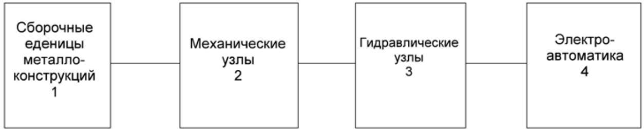
Рисунок 4.1 - Структурная схема надежности изделия
