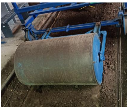
Рисунок 3.3 Процесс прикатывания почвы водоналивным катком
