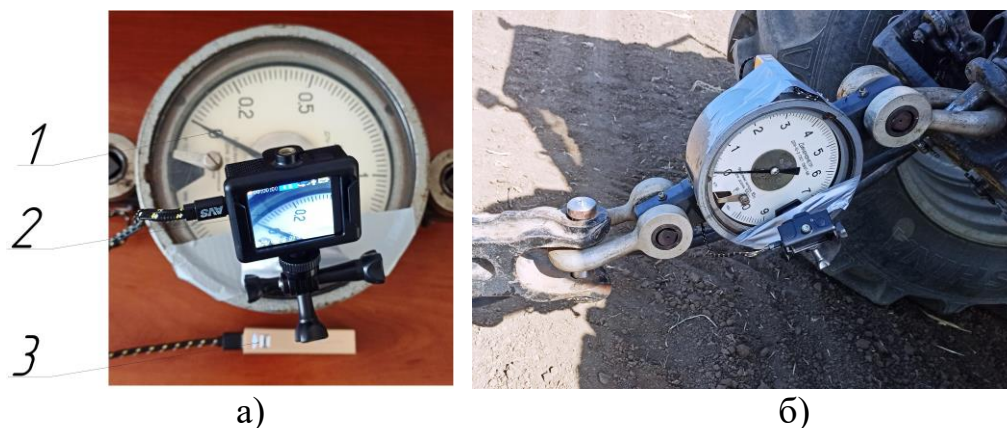
Рисунок 3.9 Приборы для регистрации полученных экспериментальных значений тягового сопротивления: а) общий вид динамометра ДПУ-10-2 – 1, камеры Ultra HD 4K 2, портативного зарядного устройства CNE-CSPB26GO – 3; б) приборы в полевых условиях
