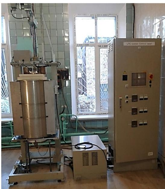
Рис. 1.1 – Общий вид установки для жидкофазной эпитаксии плёнок LPE (Daiichi Electromechanical, Токио)
