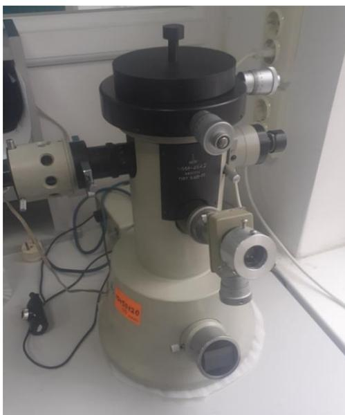
Рис. 1.4 – Микроинтерферометр Линника МИИ-4.
