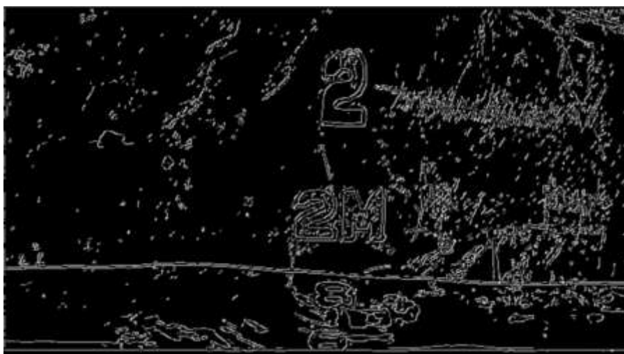
Рисунок 1.7 – Определение осадки с помощью компьютерного зрения
