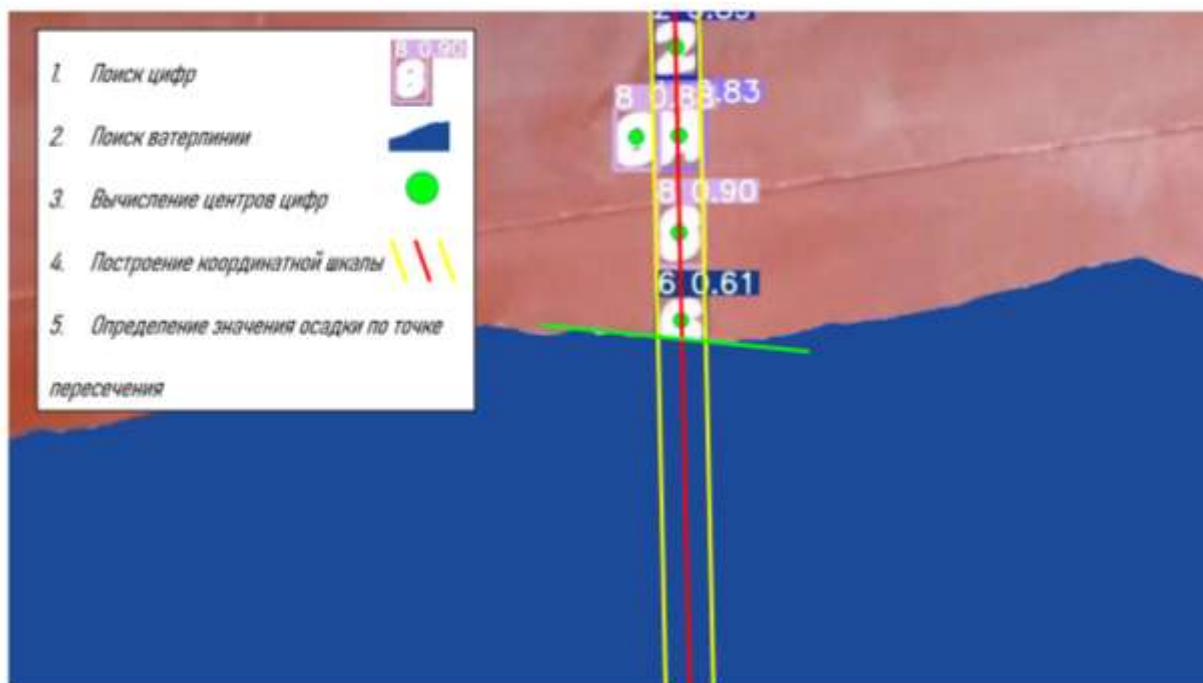
Рисунок 4.8 – Визуализация алгоритма определения осадки судна
