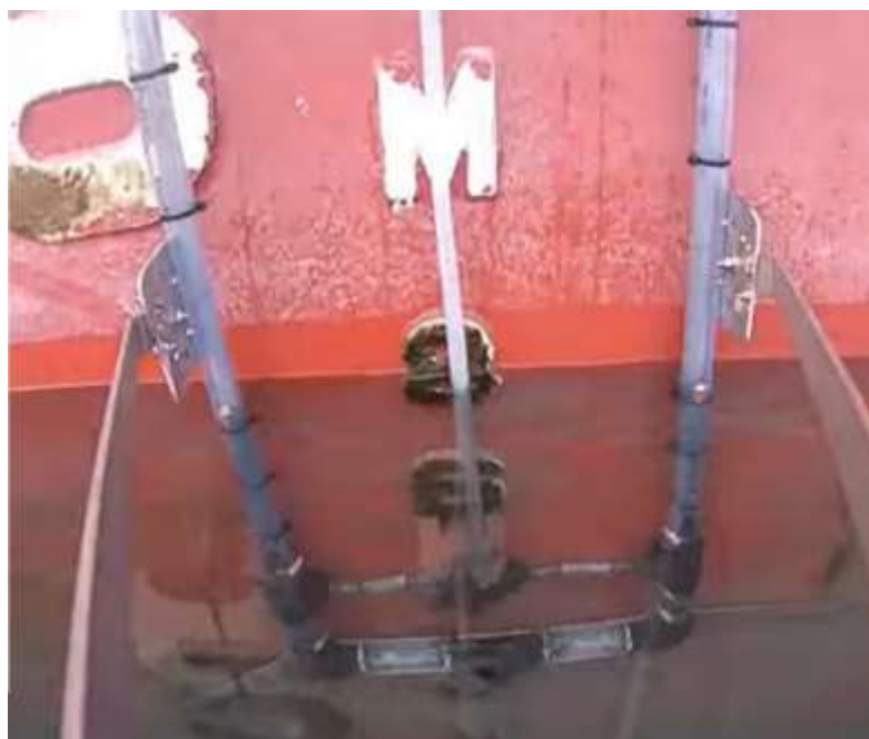
Рисунок 1.6 – Определение осадки с помощью мерительной трубки
