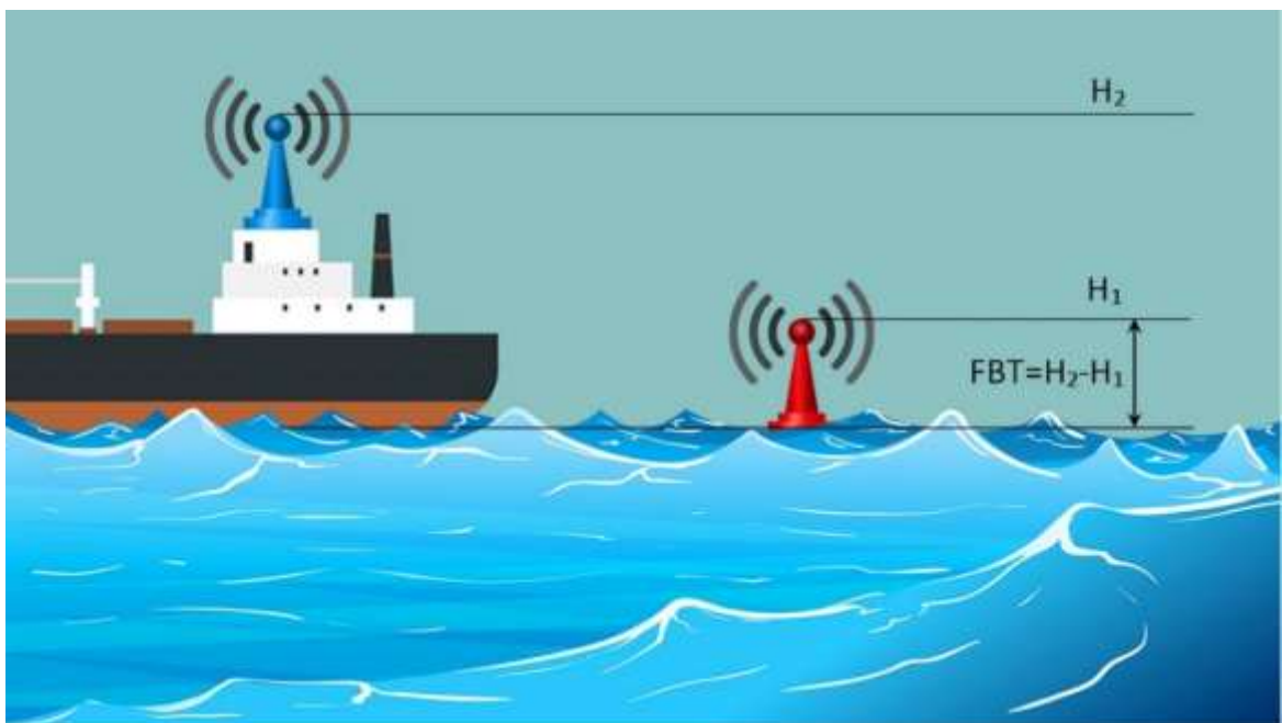
Рисунок 1.5 – Чтение осадки с помощью антенн GLONASS/GPS
