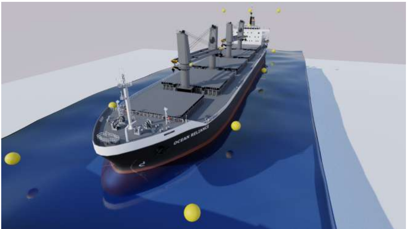
Рисунок 4.14 – Расположение путевых точек БПЛА при облете судна
